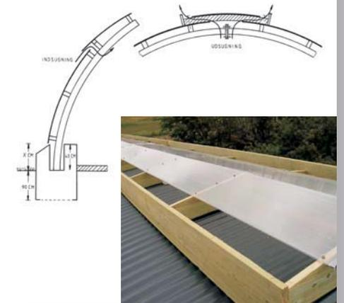
Die Bedachung erfolgt mit 0,56 mm starken, verzinkten und beschichteten Wellblechplatten. Diese können in vielen RAL-Farben (siehe Farbskala) geliefert werden. Auch eine zweifarbige Variante ist möglich.
