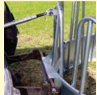
Dreipunktanhangung für Transport an der Ackerschleife
