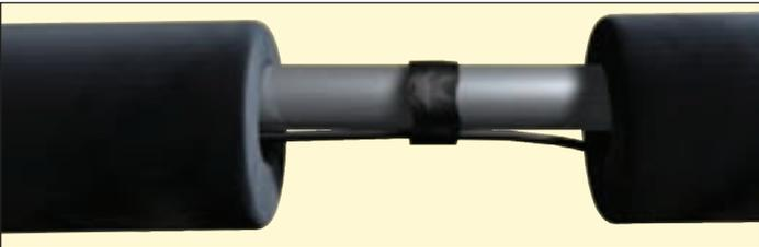
Heizkabel direkt unter der Wasserleitung verlegen und in regelmäßigen Abständen mit Isolierband befestigen; Wasserleitung zusätzlich mit Rohrisolierung von mindestens 13 mm isolieren.
