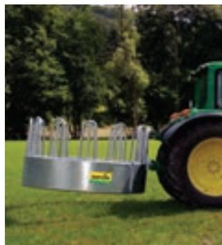
Die Rundraufe lässt sich an der Schlepperdreipunkt leicht transportieren
