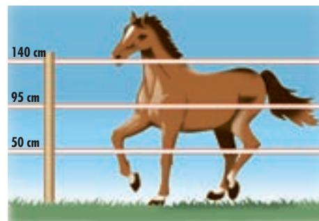
Elektrozäune für Pferde sind 1,30 m bis 1,60 m hoch, mit 2 bis 3 stromführenden Leitern.
