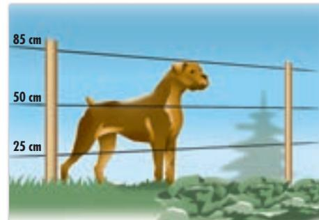
Elektrozäune für große Hunde sind 0,85 m bis 1,05 m hoch, mit 2 bis 4 Drähten.
