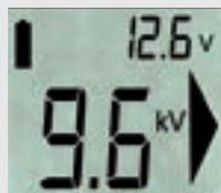
Schalterstellung 2 (Batterietest)
